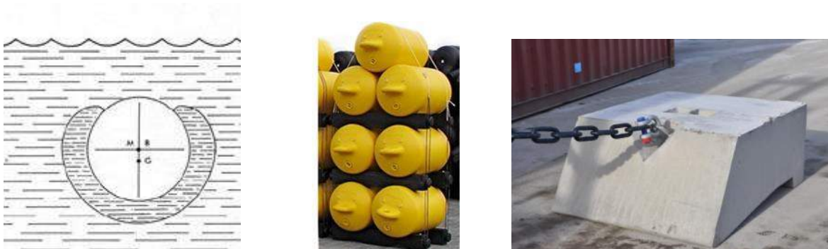
Figuur 3-2: Voorbeelden van een drijfleiding met drijvend omhulsel, beboeiing/drijvers en ankerblokken.
